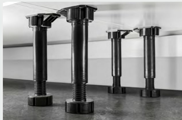
Nóżki 10 lub 15 cm wyposażone w piąty punkt podparcia, który zapewnia dodatkową podporę boków szafek dolnych. Regulacja wysokości +/- 2,5 cm.
